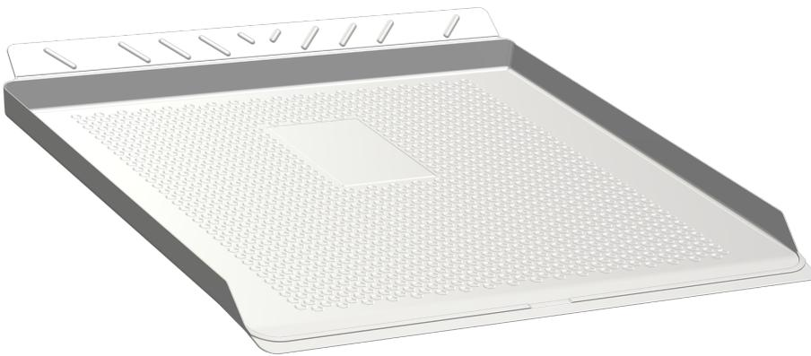
Die Kondensschutz-Elemente der Pro-Serie werden unter Kühl- und Gefriergeräten verlegt, wo sie Kondens- und Wasserschäden vorbeugen. Sie sind so konstruiert, dass sie Kondens- und Leckwasser von verborgenen Stellen unter dem Gerät zügig auffangen und vor das Gerät leiten. So lassen sich weitere Wasserschäden vermeiden.
