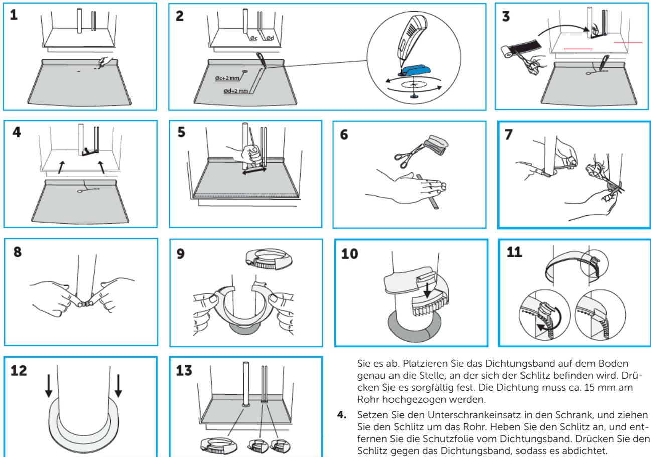
1. Messen Sie die Position der erforderlichen Aussparungen für Rohre aus, und kennzeichnen Sie sie.
